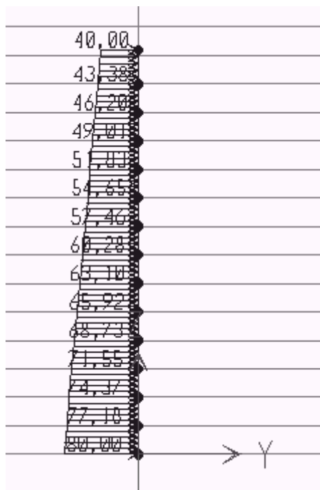
Andamento delle pressioni (carico non sismico)
